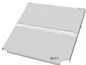
图 4 SJ-1-1 试样的焊后扫描模型
