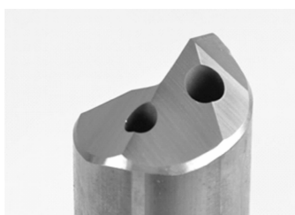
图 7 改进后枪钻前端磨削面
