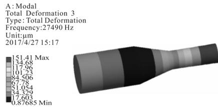
图 4 复合变幅杆位移分布云图
