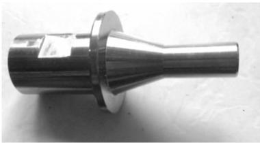
图6 变幅杆实物
