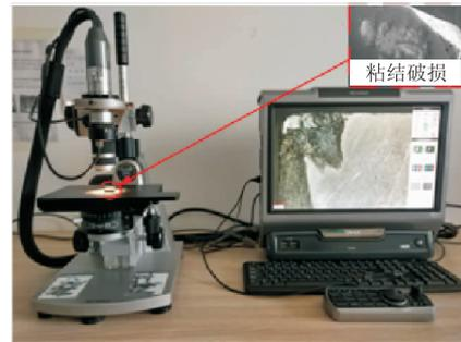
图 2 刀具粘结破损参数测量
