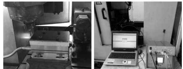
图4 玻璃纤维复合材料铣削试验平台
