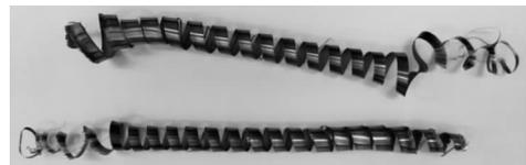
图6 倒角刀具改进后卷屑
