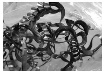
图5 刀具试验卷屑
