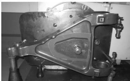
图5 零件实际装夹状态
