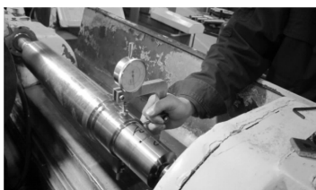
图8 新型卡板式外径千分表测量方法
