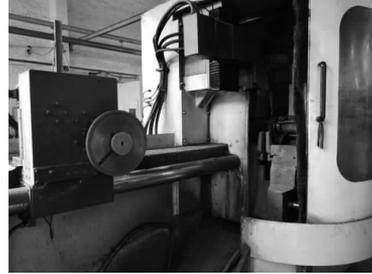
图6 圆锯片侧隙刃磨机床
