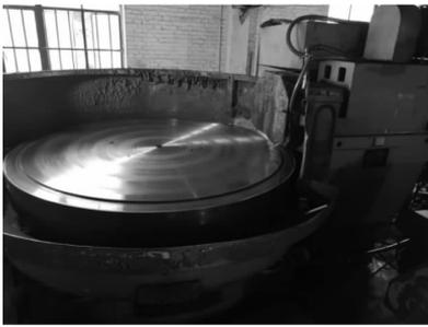
图4 卧轴圆台平面磨床
