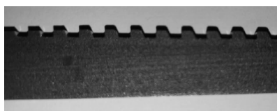
图6 倒钩型特殊螺纹
