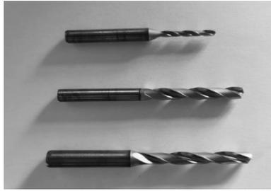
图 1 试验用硬质合金刀具
