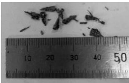
图3 2号刀切削加工时产生的铁屑(60m/min)
