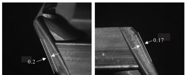
图7 3号刀两侧前刀面的磨损状况
