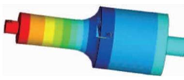
图 7 优化后阶梯型变幅杆仿真结果
