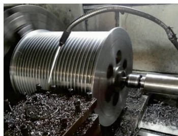
图 9 圆弧螺纹粗加工实物
