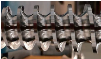
图11 圆弧螺纹最终加工实物
