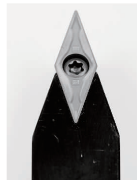
图8 精加工刀具与刀片
